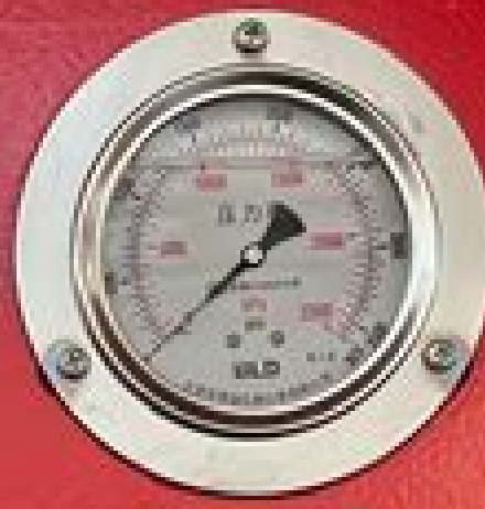
环井压力 WELLHEAD PRESSURE
